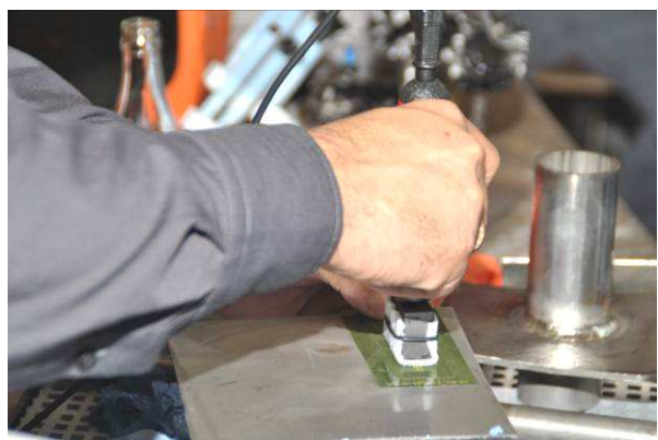
Bild 3 bis 6: Während der Vorführung erhalten die Teilnehmer einen Einblick in die materialgerechte Reinigung und das effiziente Polieren von MAG- und WIG-Schweißnähten. Mit dem gleichen Verfahrensprinzip ist auch die dauerhafte Signierung von nichtrostenden CrNi-Stählen werkstoffschonend möglich.
