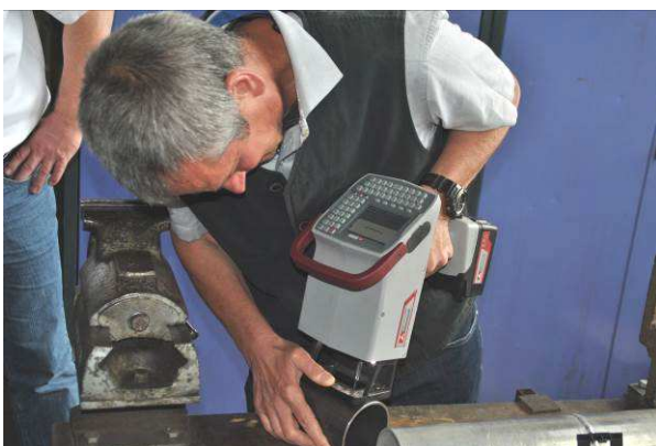
Bild 3 bis 6: Ob einfache, mechanisierte oder auch CNC-betriebene Handmarkiersysteme, die Teilnehmer erfahren hier mehr von Herrn Wolfgang Weinberg (Markator Manfred Borries GmbH) über reproduzierbares Markieren und haben die Möglichkeit, während der Vorführung auch alles selbst auszuprobieren.
