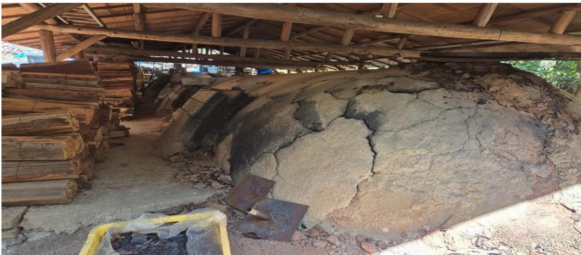
**Ofen setzen:** Die hergestellten, getrockneten und ungeschröpften Stücke werden über Wochen in den Ofen eingesetzt. Je nach Position im Ofen entstehen die verschiedensten Variationen an Oberflächengestaltung. Z.B. sind Stücke, die am Anfang stehen, intensiver einem Ascheanflug ausgesetzt als die Stücke, die am Ende des Ofens stehen.
