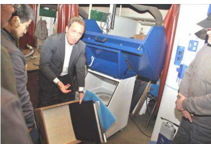
Bild 3 bis 8: Herr Waldemar Paul (TEKA Absaug- und Entsorgungstechnologie GmbH) zeigt den Aufbau eines mobilen Schweiß-, Schleif- und Absaugtisches. Während des Einsatzes in der Vorführwerkstatt sehen die interessierten Besucher den Unterschied der Schweißrauchfassung zwischen einer hocheffizienten großflächigen mobilen Unterabsaugung und einer punktuellen arretierten Runddüse.
