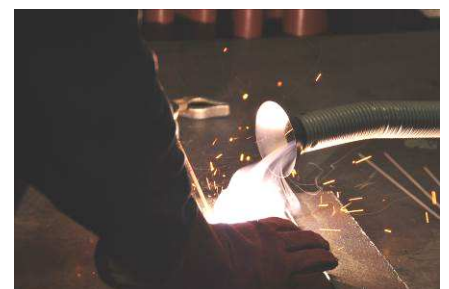
Bild 3 bis 8: Herr Waldemar Paul (TEKA Absaug- und Entsorgungstechnologie GmbH) zeigt den Aufbau eines mobilen Schweiß-, Schleif- und Absaugtisches. Während des Einsatzes in der Vorführwerkstatt sehen die interessierten Besucher den Unterschied der Schweißrauchfassung zwischen einer hocheffizienten großflächigen mobilen Unterabsaugung und einer punktuellen arretierten Runddüse.
