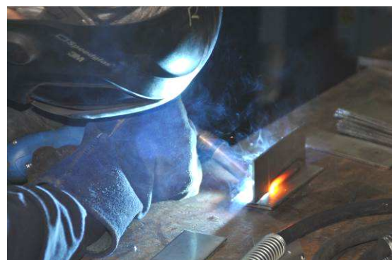
Bild 3 bis 6: Beim Schutzgasschweißprozess gelangen meist Verunreinigungen erst auf dem Weg von der Gasflasche zur Schweißstelle in das Schutzgas und führen zu Schweißproblemen. Anhand eines präparierten Schweißplatzes wird den Teilnehmern während der Vorführung gezeigt, wie und mit welchen Handgriffen man Fehlerquellen bei der Ausrüstung identifiziert.
