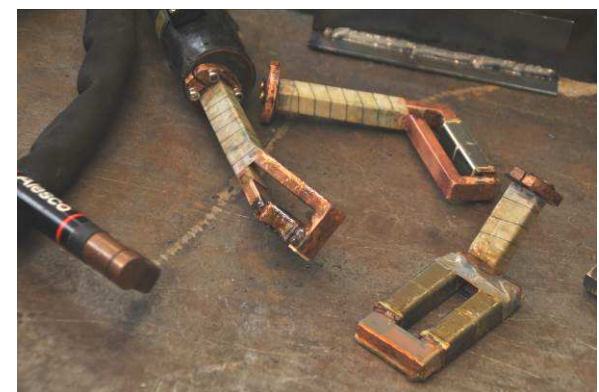
Bild 2 bis 5: Herr Thomas Vauderwange (VauQuadrat GmbH) erklärt den großen Unterschied zwischen dem Induktionsrichten und dem Flammrichten. Es wird wesentlich weniger Hitze beim Richten von Schweisskonstruktionen mit Induktionsheizgeräten erzeugt als mit der Autogenflamme. Teilnehmer können sich bei den Vorführungen mit Hilfe einer Wärmebildkamera davon selbst überzeugen.
