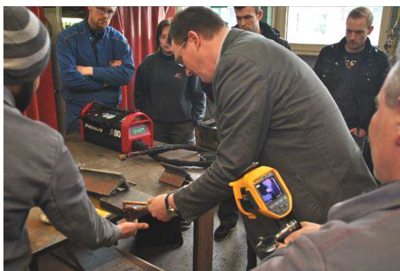
Bild 2 bis 5: Herr Thomas Vauderwange (VauQuadrat GmbH) erklärt den großen Unterschied zwischen dem Induktionsrichten und dem Flammrichten. Es wird wesentlich weniger Hitze beim Richten von Schweisskonstruktionen mit Induktionsheizgeräten erzeugt als mit der Autogenflamme. Teilnehmer können sich bei den Vorführungen mit Hilfe einer Wärmebildkamera davon selbst überzeugen.
